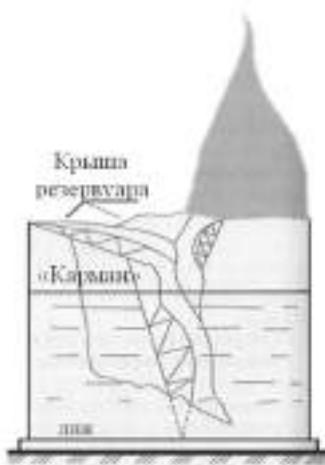
Рис. 17. Крыша резервуара, погруженная в горящую жидкость
