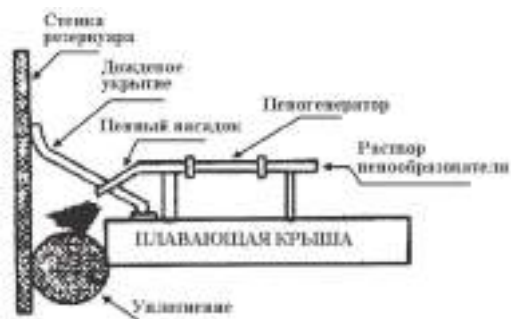
Рис. 20. Расположение пеногенерирующей аппаратуры на плавающей крыше
