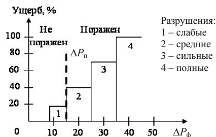
Рис. 16.1. Оценка поражения объекта (малоэтажное кирпичное здание)
