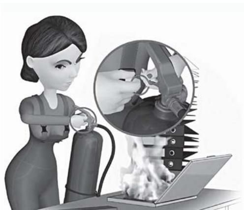
Рис. 50. Приведение в действие огнетушителя
