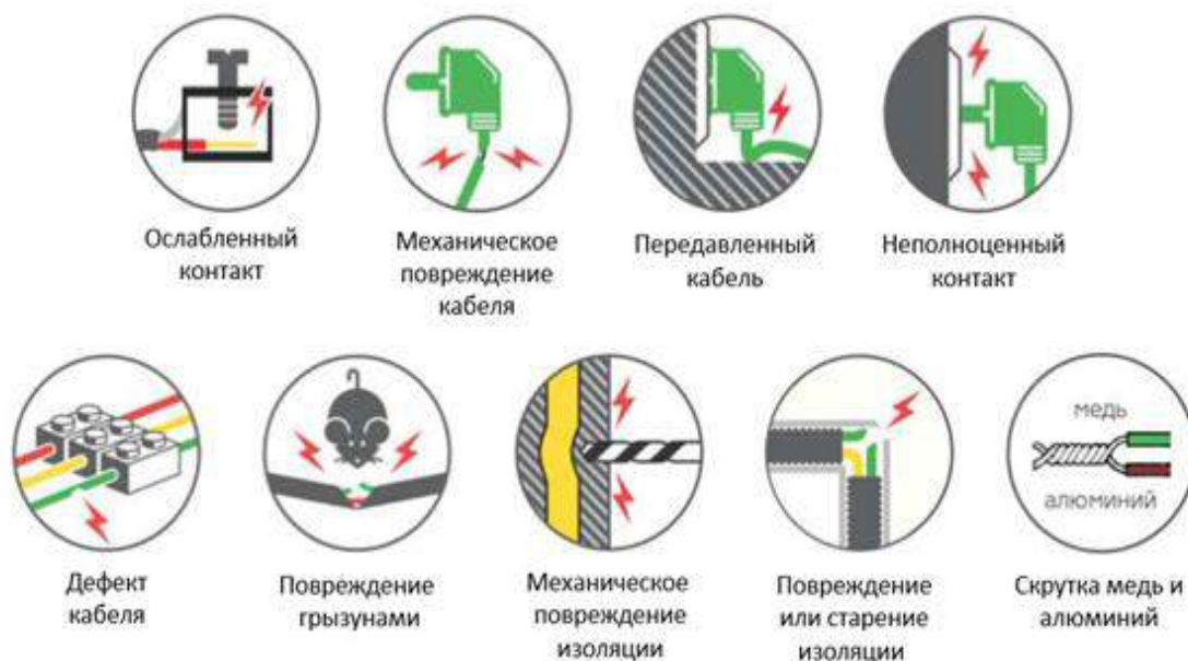
Рисунок 6. Возможные причины искрения в электропроводке
